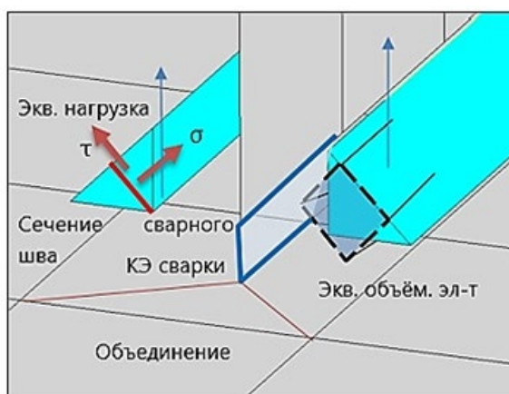
Рисунок 1.6 – Модель сварного шва в IDEA StatiCa .
