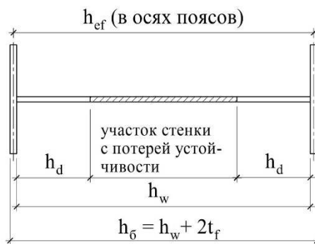
Рис.8.5. К учету редуцированной площади сечения стержня колонны
