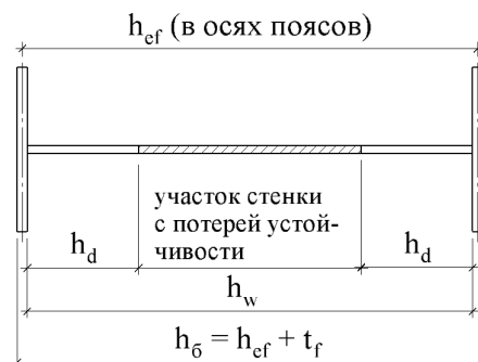
Рис.8.5. К учету редуцированной площади сечения стержня колонны
