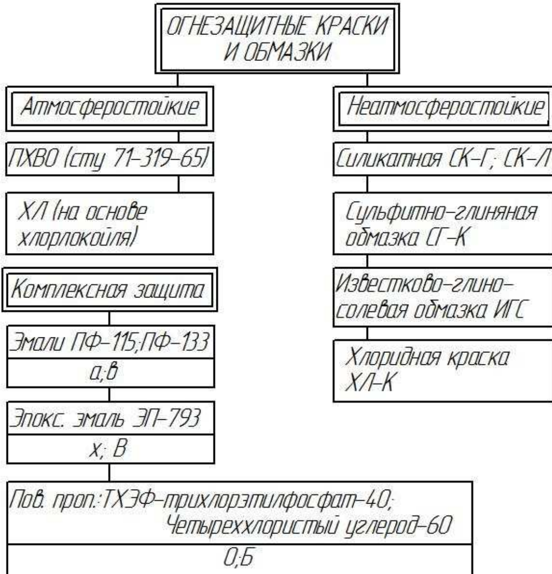
Рис. 1.11. Основные антипирены, огнезащитные краски и обмазки
