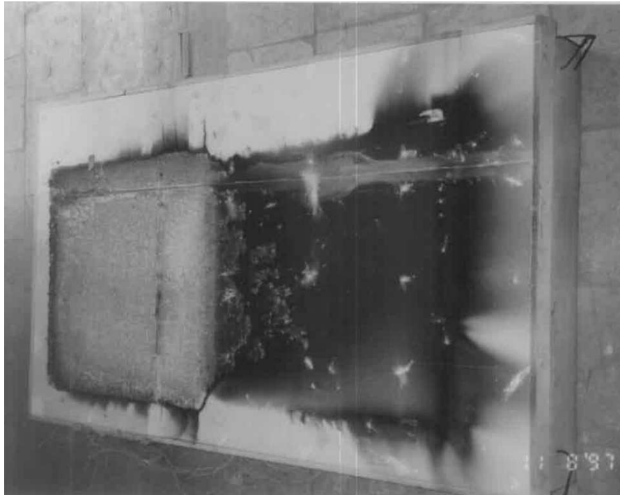
Рисунок 11.4. Обогреваемая поверхность конструкции, испытанной фирмой “VELUX”
