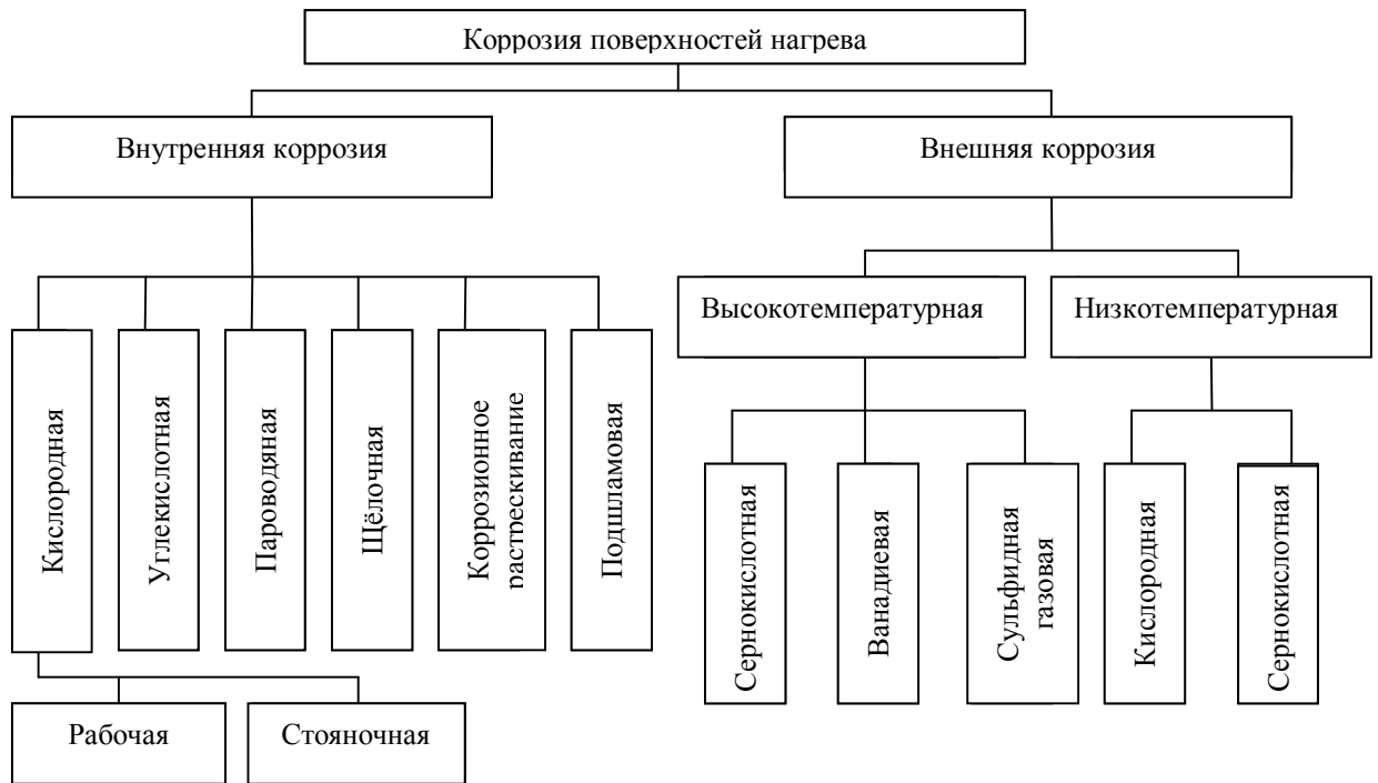
Рис 1. Систематизация основных видов коррозии поверхностей нагрева котлов [3]
