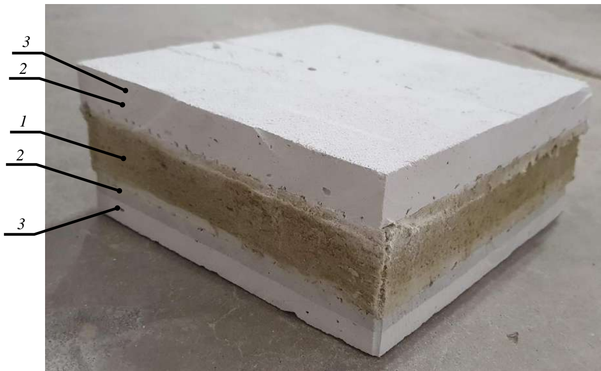
Рис. 3. Фрагмент исследуемого образца сэндвич-панели с торкрет-облицовками: 1 – средний слой из жесткой минеральной ваты (толщина 50 мм); 2 – торкрет-облицовки, нанесенные на первом этапе эксперимента (толщина по 12 мм); 3 – торкрет-облицовки, нанесенные на втором этапе эксперимента (толщина по 12 мм)
