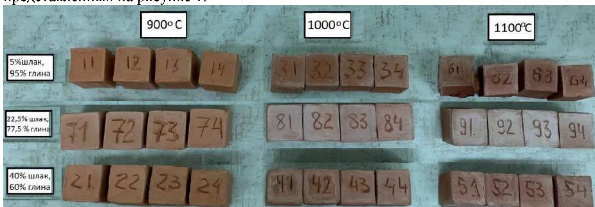
Рис. 1. Фотография образцов, обожженных при температуре 900, 1000 и 1100°C., с добавкой никелевого шлака 5, 22,5, 40 %
