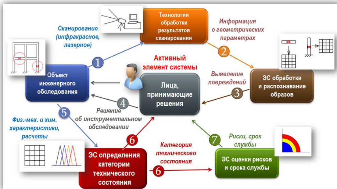
Рис.1. Структура комплексной интеллектуальной системы диагностики строительных объектов
