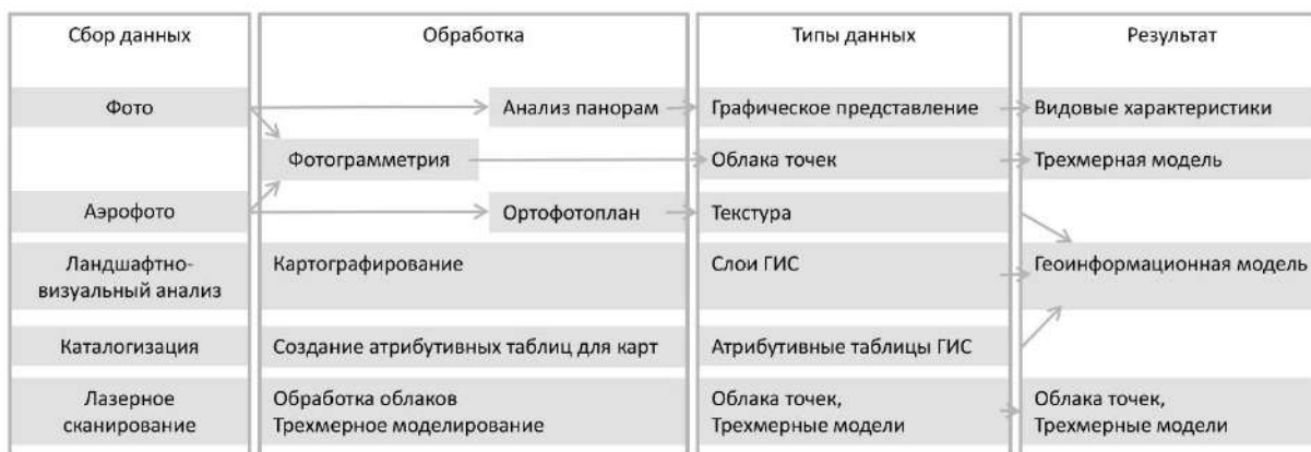
Рис. 6. Схема обработки данных об историко-архитектурной среде и результат
