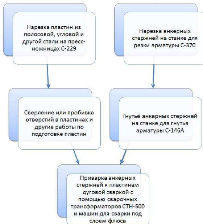
Рис.3.16. Схема изготовления закладных деталей
