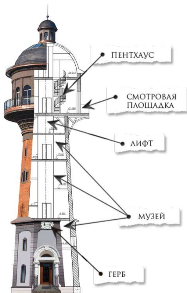
Рисунок 2.5.2 – Разрез водонапорной башни г. Зеленоградск. Источник: https://murarium.ru/
