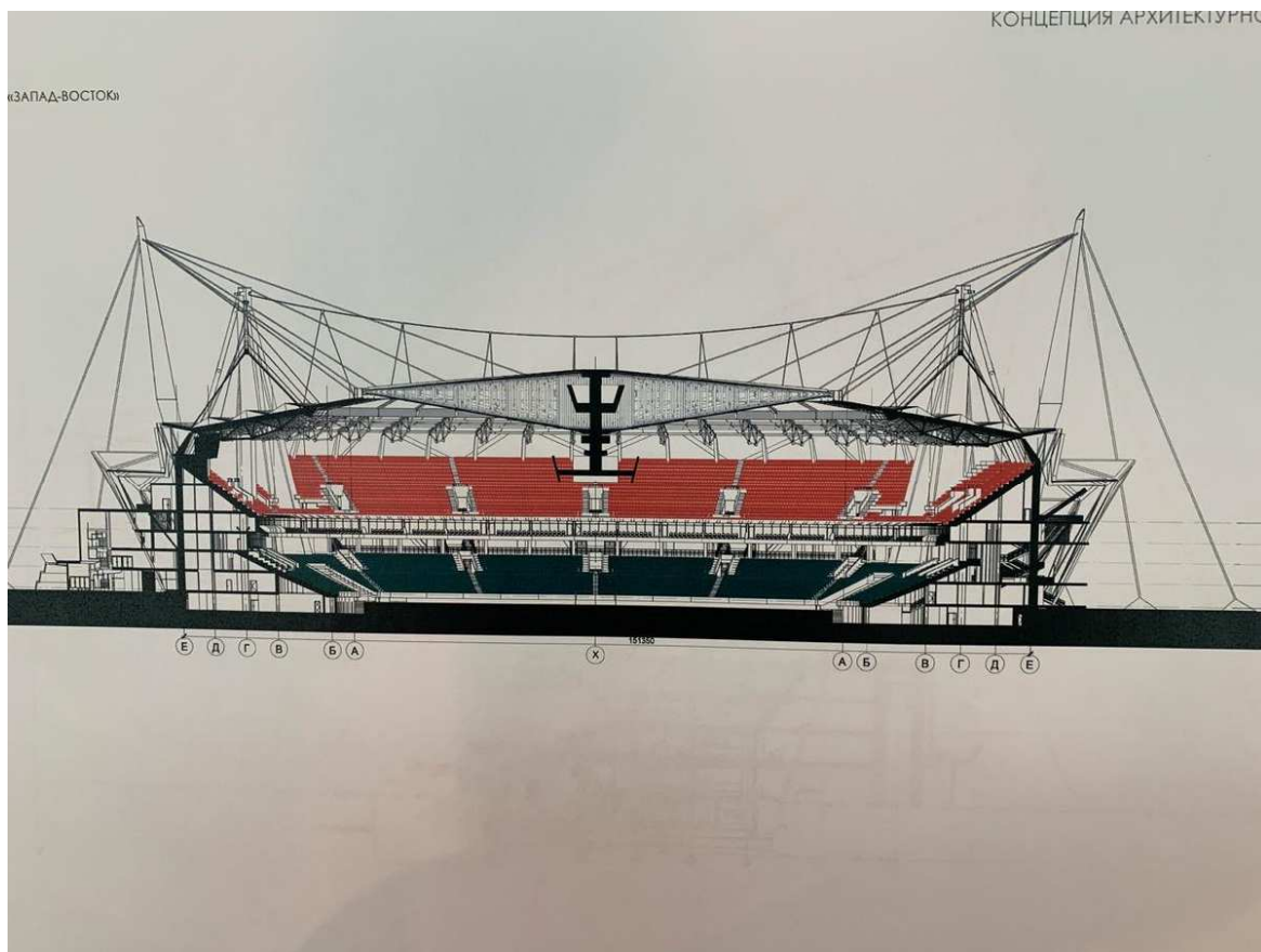
Рис. 3.4. Проект разреза стадиона «РЖД-Арена»
