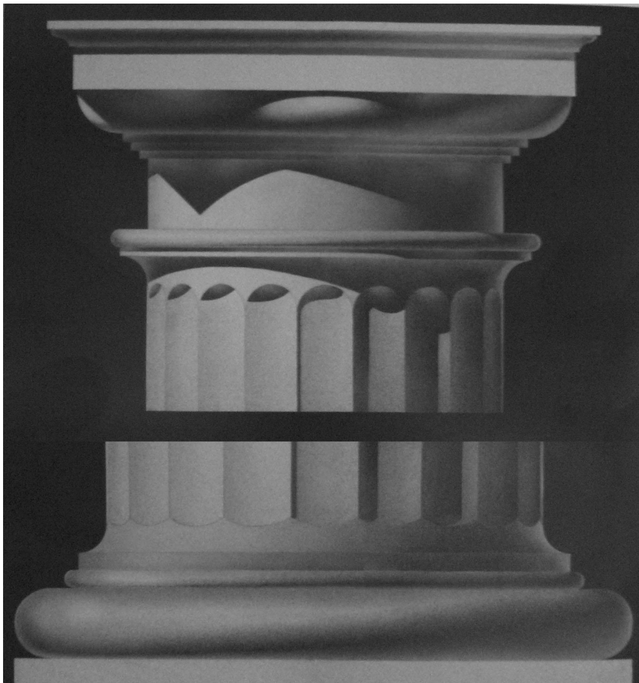
Рис. 27. Капитель и база дорического ордера
