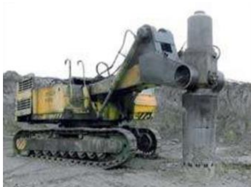
Рис. 26. Глубинное уплотнение оснований фундаментов
