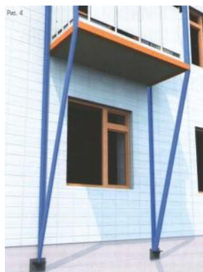
Рис. 67 . Усиление с помощью стоек, опирающихся на консоль, закрепленную в фундаментном блоке.
