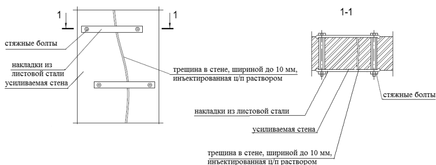
Рис. 41. Заделка трещин в кирпичных стенах металлической накладкой.
