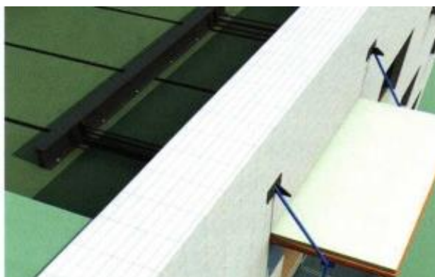
Рис. 66. Усиление плиты с помощью подвесок.
