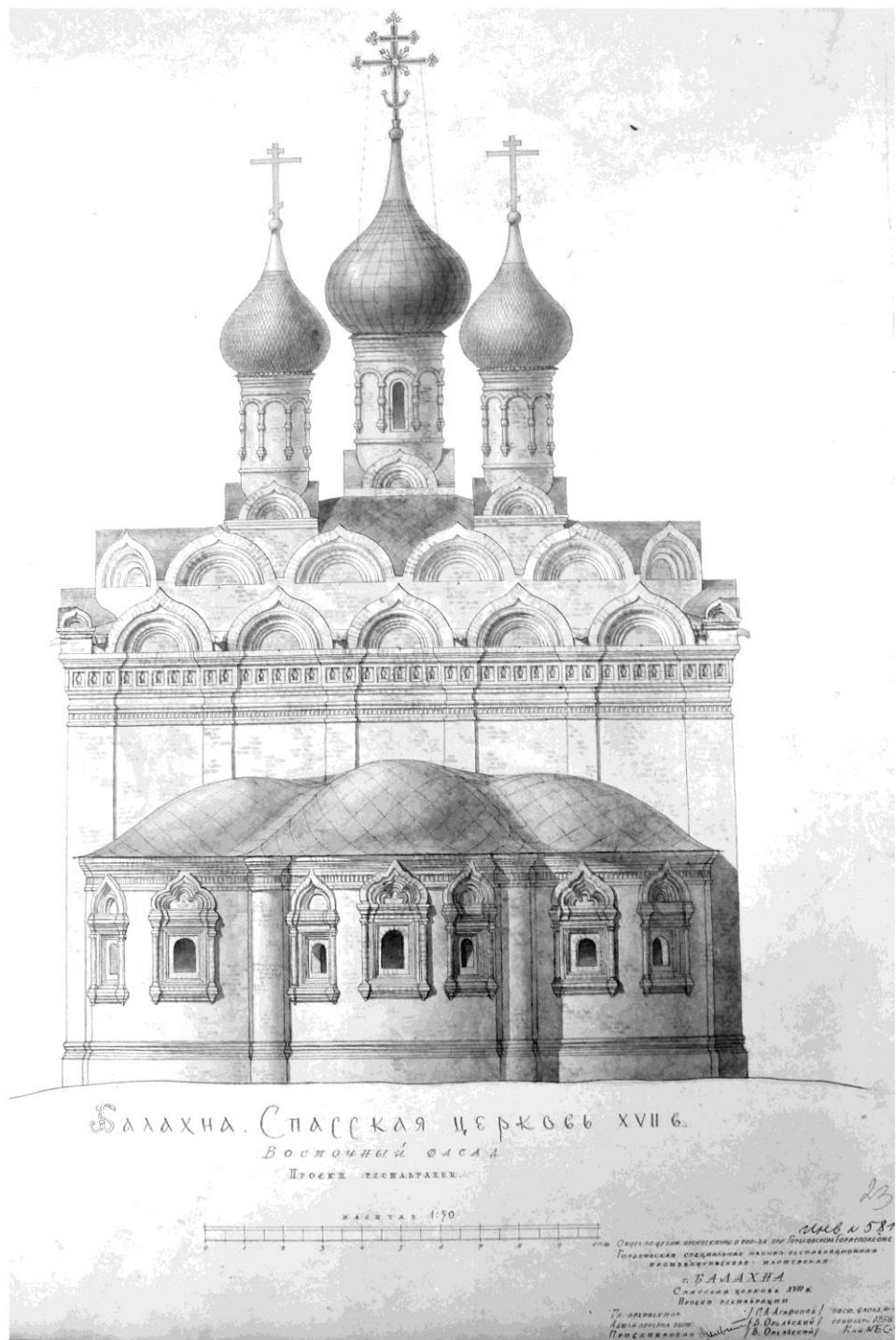
Рис. 70. Спасская церковь в Балахне. Восточный фасад. Проект реставрации, арх. В.В. Орельский, 1958 г.
