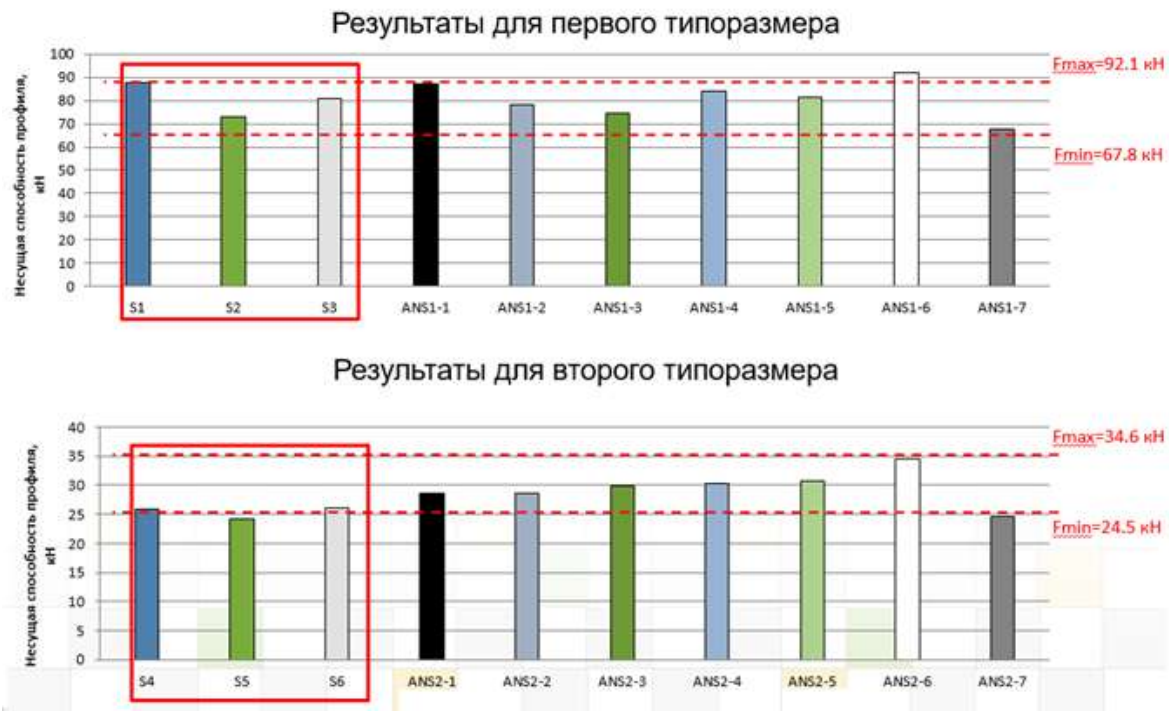
Рис. 7. Результаты натуральных экспериментов канадской лаборатории "Bodycote" и компьютерного моделирования
