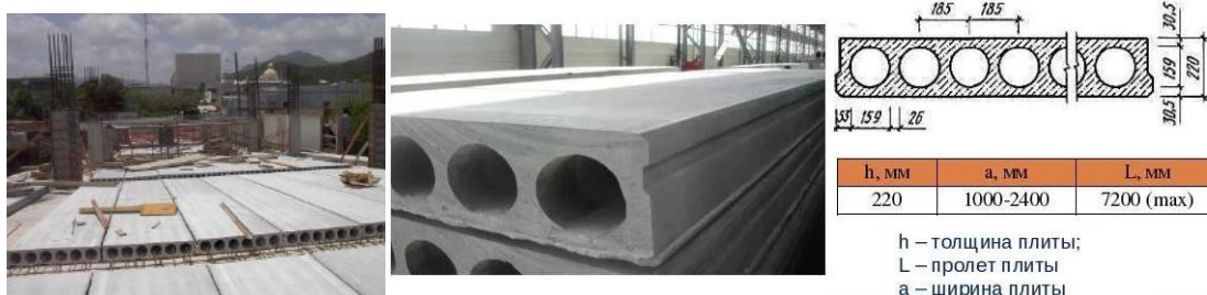
Рис.2.12. Многопустотная плита перекрытия
