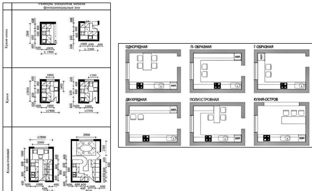
Рис.1.33. Минимальные габариты и площади кухни в квартире, виды оборудования рабочей зоны кухни
