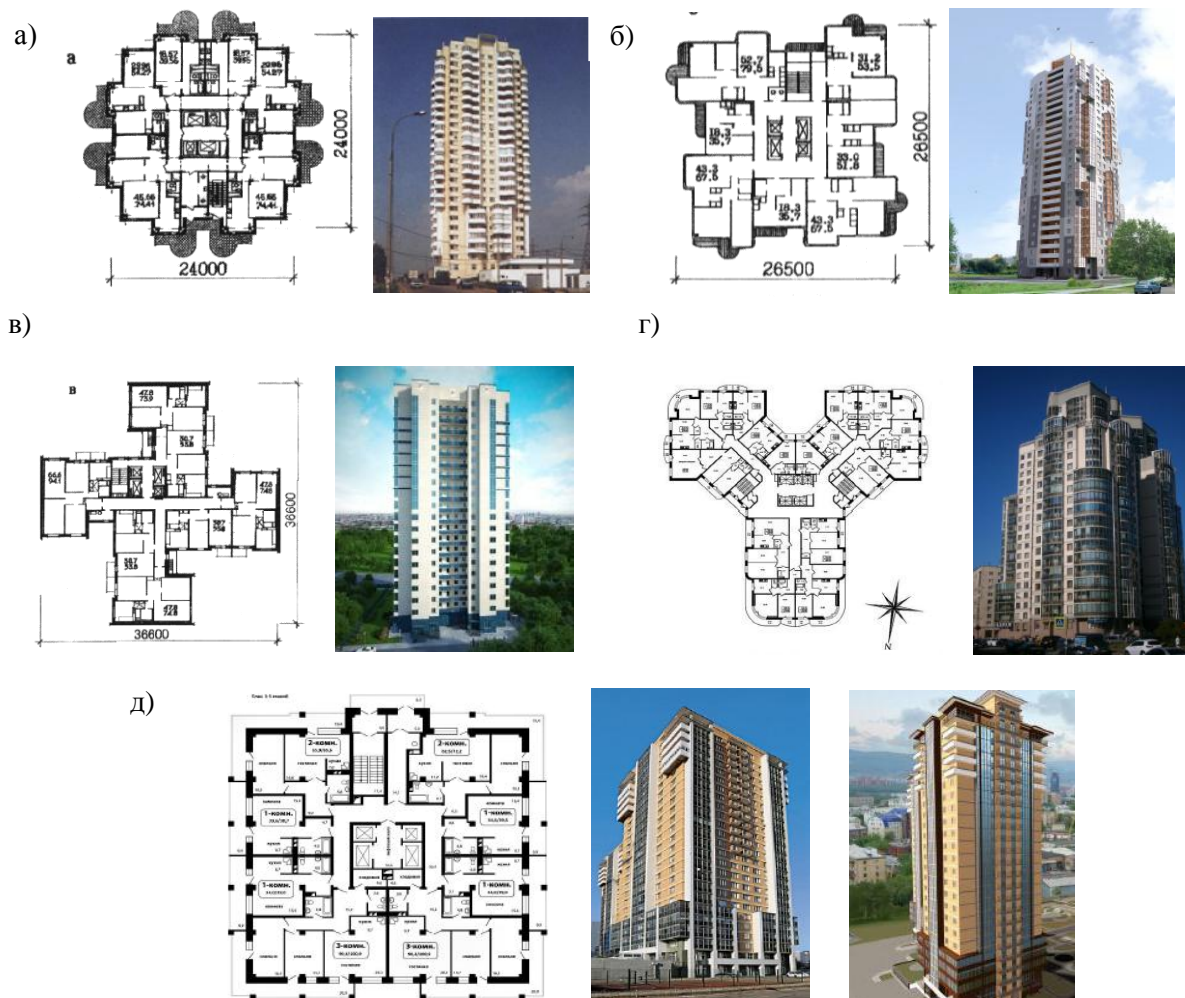
Рис. 1.16. Односекционные жилые дома: а - 24-этажный жилой дом центральной композиции АО Моспроект, Арх. Скулимовский М.; б - 25-этажный жилой центральной композиции МНИИТЭП. Арх. Саруханян Р.; в - 22-этажный жилой центральной композиции МНИИТЭП. Арх. Самсонов А.; г - трехлучевой башенный дом "Норд", Гражданский пр,113 центральной композиции; д - Односекционный башенный жилой дом ЖК "Взлетный" г. Красноярск центральной композиции
