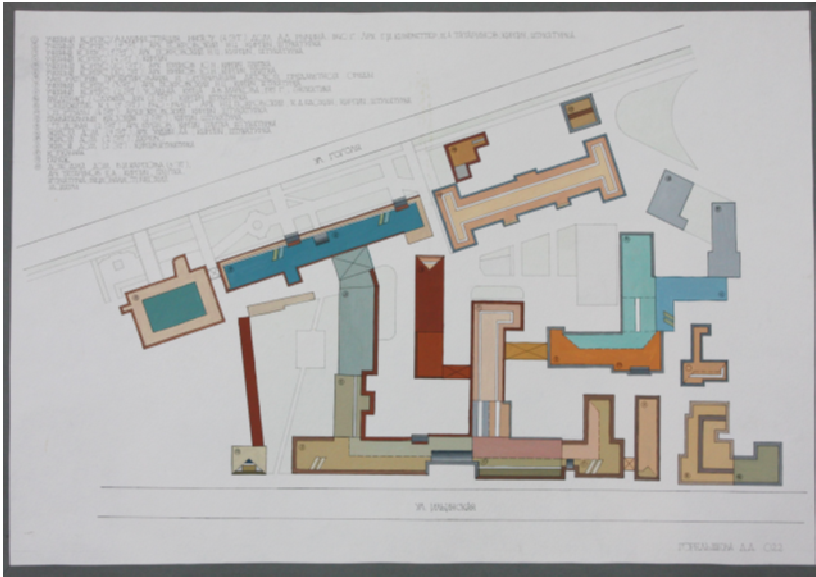
Рис.4. Генплан с фиксацией существующего колористического состояния квартала ННГАСУ в границах ул. Ильинской, Гоголя. Ст. Горельшьева Д. гр.022, 2010 г. На представленной работе показаны основные нюансы цветовой ситуации. В экспликации по каждому дому указывается: год постройки, архитектор, этажность, материал, историческая ценность.
