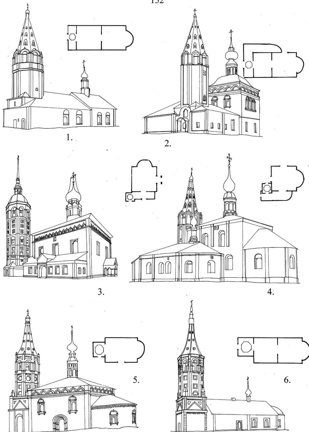
Рис. 142. Сравнение объемных композиций церквей с колокольнями XVII-XVIII вв. в Суздале. Церкви XVII в.: 1- Крестовоздвиженская, 2- Тихвинская; церкви XVIII в.: 3- Вознесенская, 1720 г., 4- Козьмодемьянская, 1725 г., 5- Никольская, 1739 г., 6- Антипиевская, 1745 г. Проявление барокко в усилении декора и силуэта колоколен
