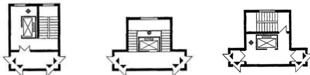
Рис. 4. Примеры обычных лестничных клеток
